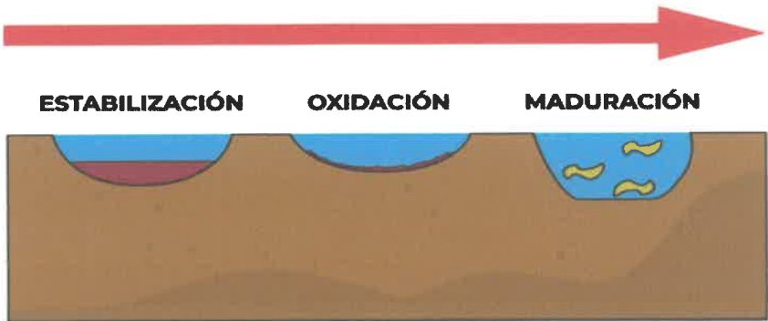
Figura 2. Esquema general de funcionamiento de una laguna de estabilización
