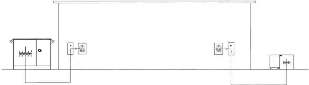
SERVICIO 120/208V TRIFÁSICO SERVICIO 120/240V MONOFÁSICO
