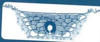
Sección transversal de alcantarillas construidas con tubos de concreto.
