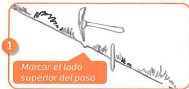
**Paso 1.** Determine la línea central del sendero para posteriormente medir la mitad del ancho del trazado de huella hacia la parte ascendente del sendero. Mediante un pico u otro implemento para cavar, trace una línea que indique el lado superior del sendero. Elimine la materia orgánica de la superficie, para determinar el borde superior.
