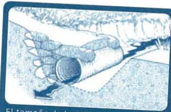
El tamaño de la tubería de desagüe dependerá del volumen de agua que cruza el sendero, la frecuencia y la fuerza de la lluvia.
