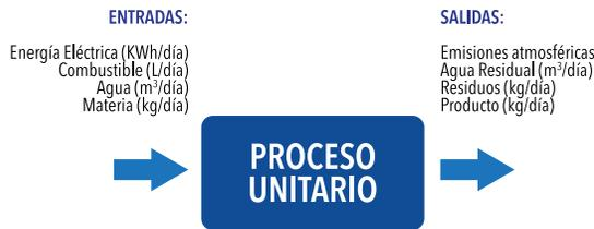
Imagen 3.3. Ejemplo de Balance de Materia en un Proceso Unitario
