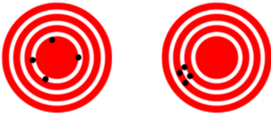
Figura 8. Ejemplo que ilustra los conceptos de exactitud y precisión
