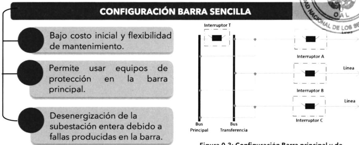
Figura 0.3: Configuración Barra principal y de transferencia.
